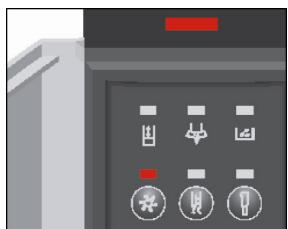
当程序面板内保养指示灯亮起时，表示咖啡机需要做相应的保养，如左图所示清洗指示灯亮起，表示咖啡机需要马上进行清洗。
